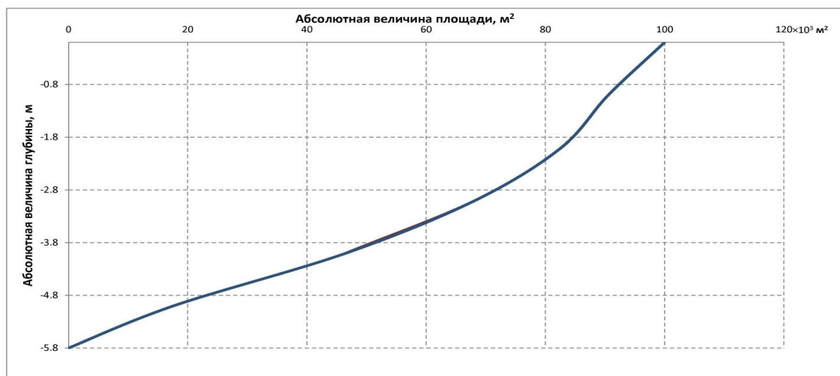
Рис. 2. Батиграфическая кривая озера Бельское (X – площадь сечения водной толщи, кв. м; Y – глубина, м)
