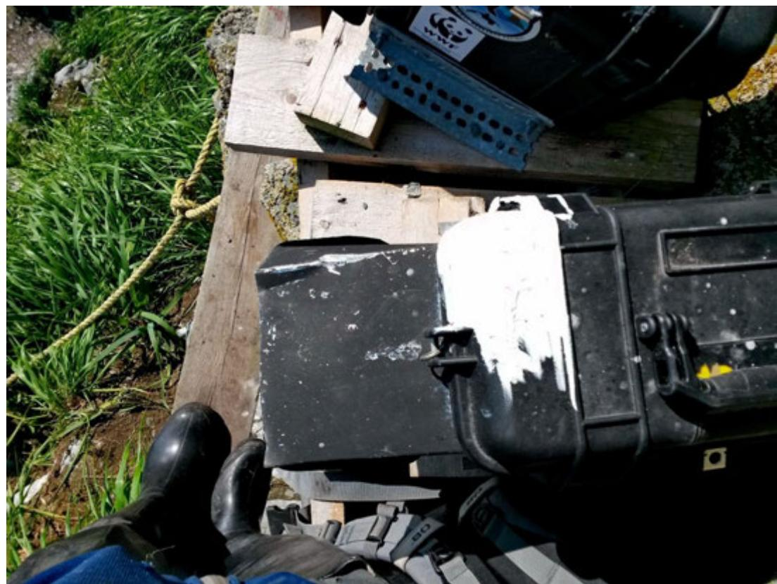
Рисунок 18. Влагозащитный ящик «Пеликан» после ремонта специальным герметиком.
